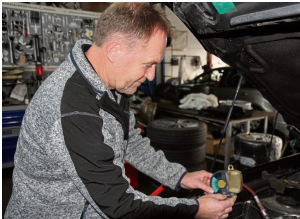
Kfz-Meister Thomas Lochner prüft den Frostschutzgehalt des Kühlwassers an einem Auto.
