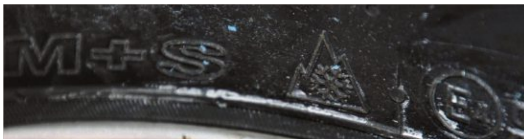
Dieses „Alpine“-Symbol muss jeder Winter- und Allwetterreifen tragen. Der „M+S“-Aufdruck alleine reicht nicht mehr aus.
