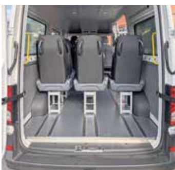
Blick in den neuen Bus, dessen Sitze über ein Schienensystem leicht verschoben werden können.
