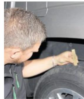
Timo Hartwich misst die Profiltiefe der Reifen bei diesem Fahrzeug.
