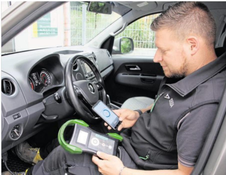
Dekra-Prüfingenieur Timo Hartwich checkt das Fahrzeug mit einem speziellen Testgerät und einem Handy auf mögliche Fehler. Bild: kro
