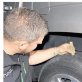
Timo Hartwich misst die Profiltiefe der Reifen bei diesem Fahrzeug. Bild: kro
