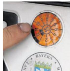
Die Fahrzeug mit der Zahl „8“ oben, musste im August 2025 zur Hauptuntersuchung. Bild: kro
